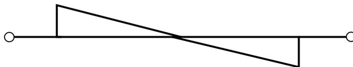
VDR digunakan untuk menahan tegangan yang naik secara tiba-tiba dan dalam jumlah yang besar guna melindungi sirkuit yang lainnya.
