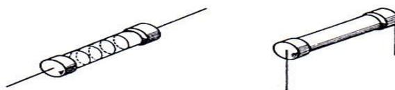
Gambar 4.2 Hambatan Karbon yang diupkan Aksial dan Radial
